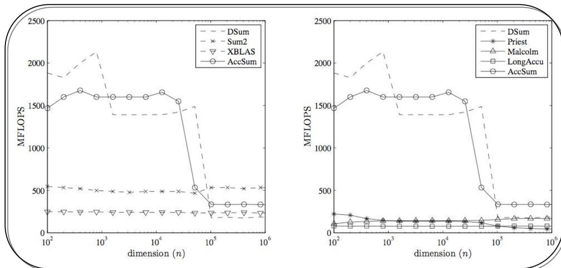
**図 21.** 各総和計算アルゴリズムの性能評価 (横軸: 次元数、縦軸: MFLOP/s)
