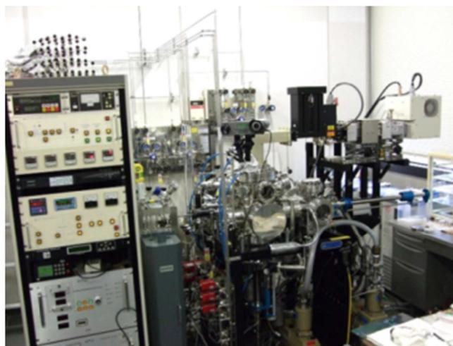
Fig.3 本プロジェクトで用いたマイクロ波プラズマ CVD 装置
