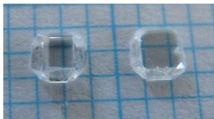
図 1  $^{12}\text{C}$  99.995%濃縮 HPHT 結晶
