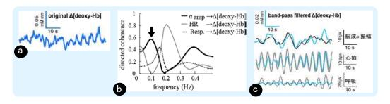
図 3-18 (a) あるエポックの光トポグラフィ信号波形、(b) このエポックの偏有向コヒーレンス解析の結果: 脳波から 光トポグラフィ信号への偏有向コヒーレンス(黒太線)、心拍から光トポグラフィ信号への偏有向コヒーレンス(灰色太線)、呼吸から光トポグラフィ信号への偏有向コヒーレンス(黒点線)、(c) 偏有向コヒーレンスの数値が高い周波数帯域のバンドパスフィルタを光トポグラフィ信号にかけた場合の、脳波(上段)、心拍(中段)、呼吸(下段)との比較。
