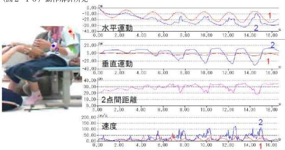
表2の#の症例のリズム刺激に対する体幹と手の動きの動作解析。1: 左肩(体幹)の動き、2: 左手の動き。時間0.00で音によるリズム刺激を開始すると、まず体を前後方向へ揺らす常同運動が主に水平方向に出現した。その体幹の動きに乗って、しだいに手を随意的に垂直方向に動かす運動がしだいに大きく出現した。
