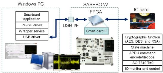
図 1. SASEBO-W と IC カードを利用した評価プラットフォームの構成
