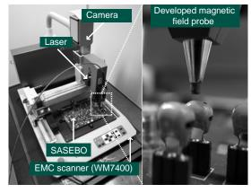
図 1: モジュール近傍の電磁波計測システムの概観
