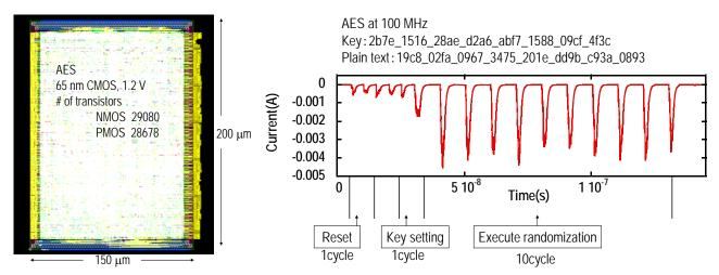
図 1: AES 暗号コアの CMOS 実装
