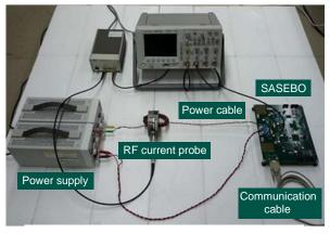
図 2:モジュール遠方の電磁波計測システムの概観
