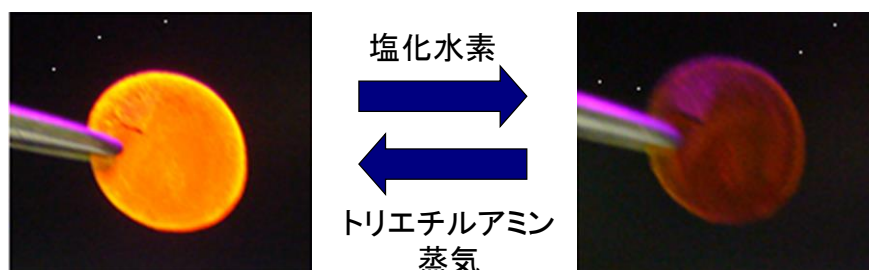
図10 ユウロピウムイオンを含む有機/金属ハイブリッドポリマーにおけるベイポルミネセンス ( Chem. Commun. , 48, 4947 (2012))
