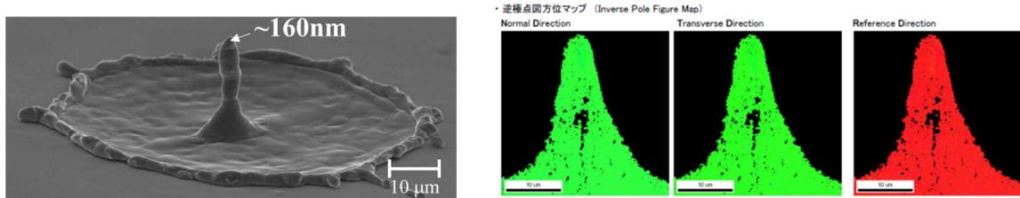
図 4-1 ピコ秒パルス・トポロジカル光波を単結晶シリコンに照射した場合にできる単結晶性シリコンニードル。高さは~15μm、先端曲率半径は~160nm。ニードル断面内のすべての領域で(101)の方位を有する。
