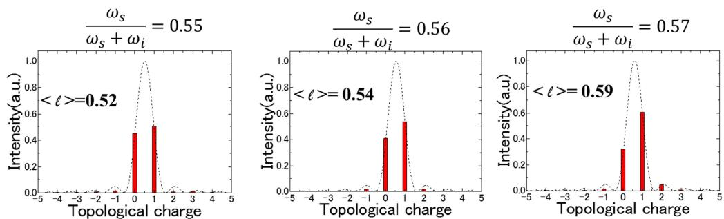
図 2-7 非整数トポロジカル光波の実効的なトポロジカルチャージ。シグナル光の周波数増加に対応してトポロジカルチャージも大きくなる。
