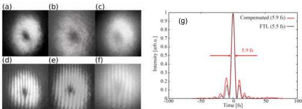
図 6-2 光パラメトリック増幅後のトポロジカル光波の(a)-(c)ビームプロファイルおよび(d)-(f)自己参照干渉像。
