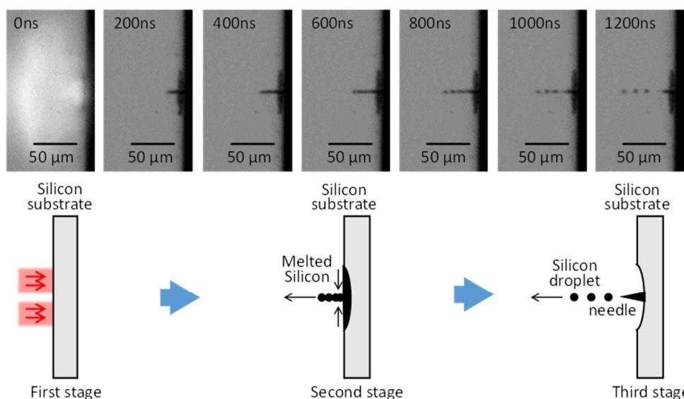
図 4-3 トポロジカル光波照射によるシリコンニードル形成のダイナミクス。溶融したシリコンが位相特異点に集まり、ニードルとして成長する。余剰のシリコンが球形の液滴(微粒子)となり飛翔し、先端の先鋒的なニードルが完成する。パルス照射後~1μs程度要する。
