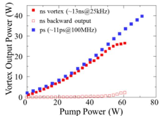
図 1-3 実験結果(レーザーの入出力特性)。
