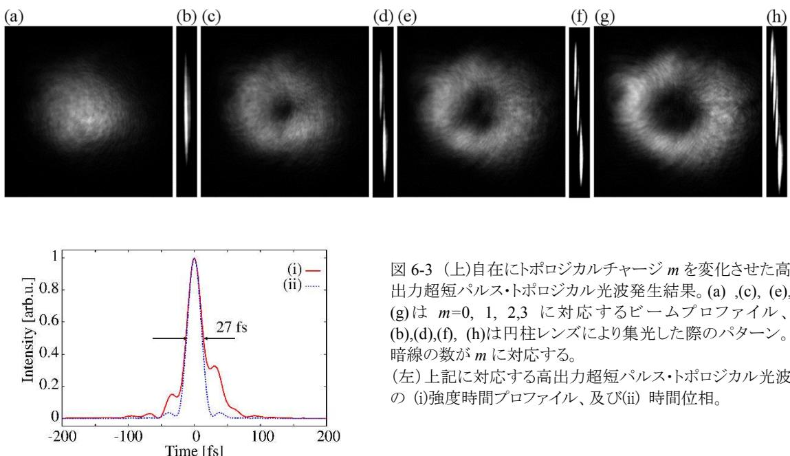
図 6-3 (上)自在にトポロジカルチャージ  $m$  を変化させた高出力超短パルス・トポロジカル光波発生結果。(a), (c), (e), (g)は  $m=0, 1, 2, 3$  に対応するビームプロファイル、(b), (d), (f), (h)は円柱レンズにより集光した際のパターン。暗線の数が  $m$  に対応する。
