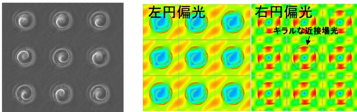
図 3-10 作成した右手系 2 次元キラル表面レリーフアレイ(左)。右円偏光を照射した場合のみ、その表面には周回方向に沿って位相が  $2\pi$  変化する近接場光(トポロジカル近接場光)が発生する。
