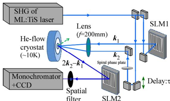
図 7-1 励起子重心系への軌道角運動量のコヒーレント転写とそのダイナミクス測定のための四光波混合分光実験系。
