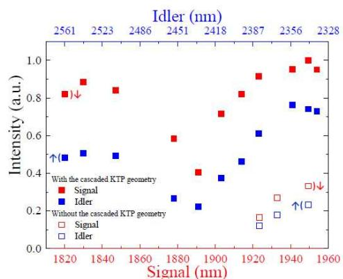
図 2-3 シグナル光、アイドラー光の同調曲線。比較のため共振器内の KTP が 1 個の場合もプロットしてある。エネルギーが低く波長可変範囲も狭い。
