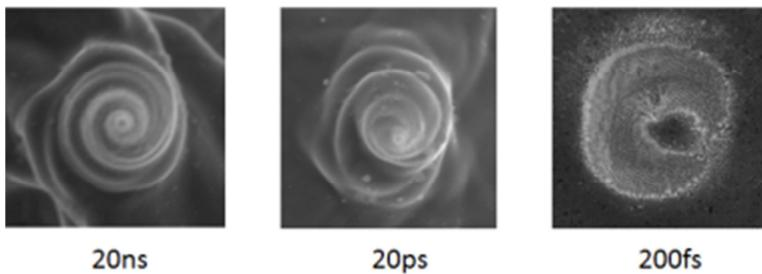
図 3-4 トポロジカル光波のパルス幅を変えた時のナノ構造体の SEM 画像。螺旋構造ができるには数 10 ピコ秒のパルス幅が必要であることがわかる。
