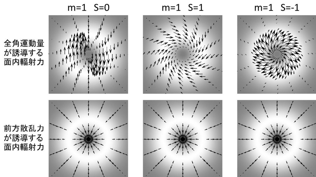
図 3-9 トポロジカル光波が物質に及ぼす輻射力の空間分布。 $m$  と  $s$  の符号が同符号の場合のみ、螺旋状の中心力が働く。逆符号の場合は前方散乱力が誘導する面内輻射力と全角運動量による動径方向の輻射力が打ち消しあいアゾポリマーは単に周回運動する。 $s=0$  の場合、偏光方向は  $x$  方向。全角運動量による面内輻射力は偏光に対して垂直方向に働くが、前方散乱力による中心力が強くアゾポリマーに働くため、結果として偏光方向に質量移動が起こる。
