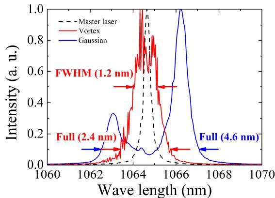
図 1-5 増幅されたラゲール・ガウスビームのスペクトル線幅。
