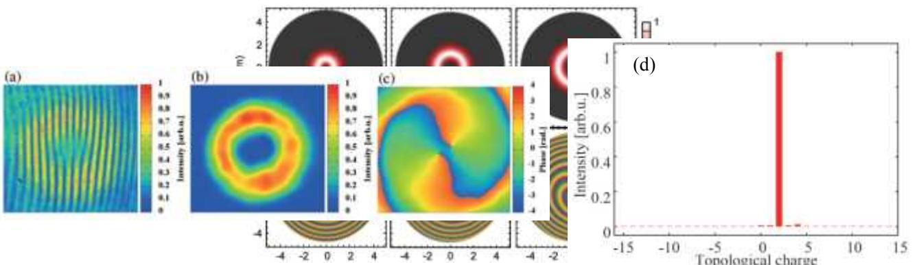
図 7-4 (a)干渉像からの電場回復により求めた(b) 強度プロファイル、(c) 位相プロファイル、(d) 軌道角運動量スペクトル(中心波長 660 nm、帯域幅 10 nm)。
