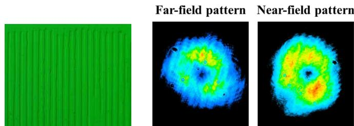
図 1-9 開発した PPSLT(左)と発生した 355nm トポジカル光波の強度分布(右)。デバイス周期 4.4μm、厚さ 1.0mm、長さ 10mm。
