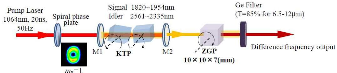
図 2-1 中赤外波長可変トポロジカル光波の実験配置図。
