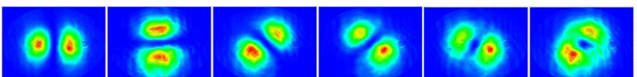
図 6-4 コヒーレント合成により発生させた超短パルス・トポロジカル光波（径偏光）ビームの偏光分布。左から順に水平、鉛直、45°、-45°、左回り円偏光、右回り円偏光成分の強度プロファイル。
