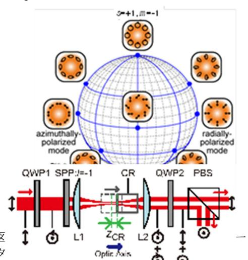
図 8-2 一軸性結晶中のトポロジカル光波(軸対称偏光)の非線形結合実験系。SPP は螺旋位相板、CR は非線形光学結晶。
