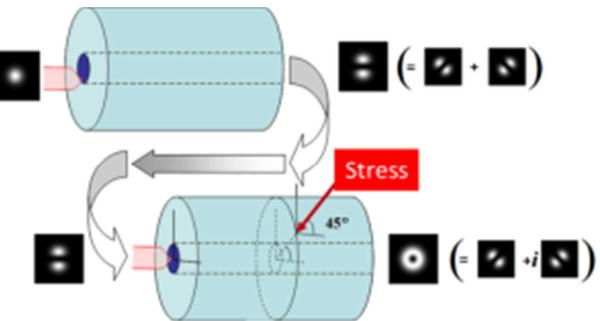
図 1-1 モード変換の基本概念図。
