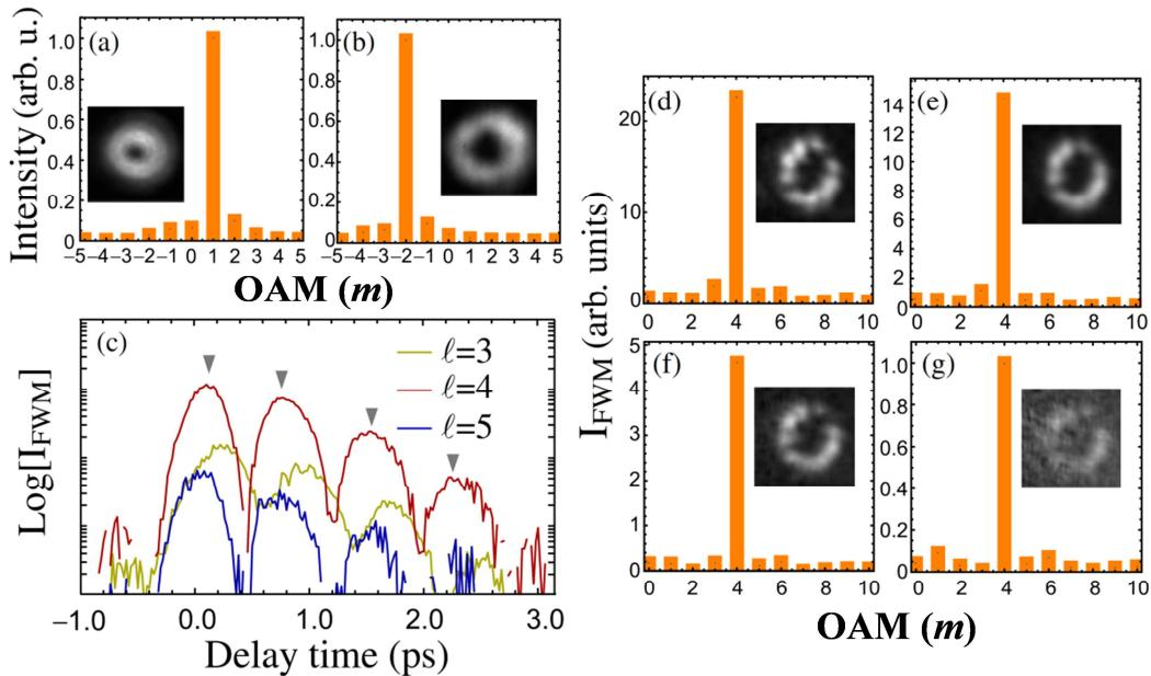
図 7-2 (a) ポンプ光( $m_1=-2$ )、(b) プローブ光( $m_2=1$ )の軌道角運動量スペクトル。(c)軌道角運動量分解四光波混合信号の時間発展、(d)-(g)は時間遅延 0.1, 0.7, 1.5, 2.2 ps のときの軌道角運動量スペクトル。挿入図はそれぞれの場合のビームプロファイル。
