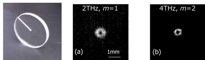
図 2-8 テラヘルツ螺旋位相板(Tsurupica 製)と(a)2THz および(b)4THz テラヘルツ・トポロジカル光波。
