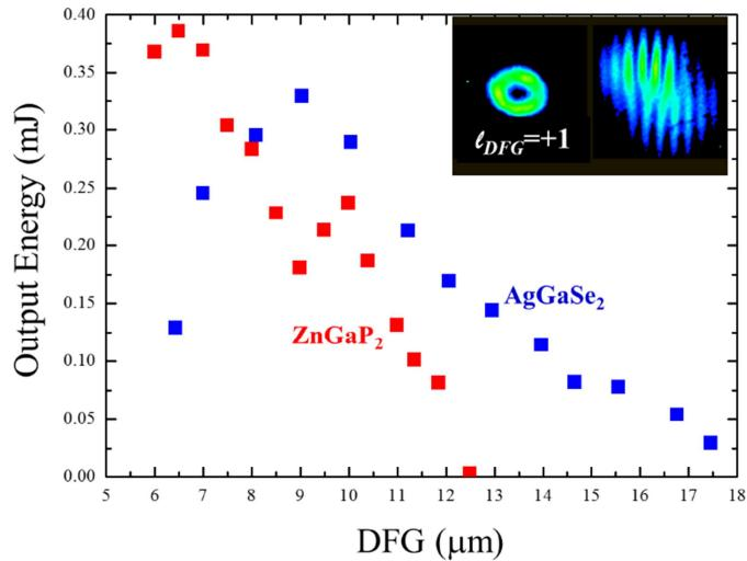
図 2-5  $\text{AgGaSe}_2$  を用いた中赤外トポロジカル光波の同調曲線。
