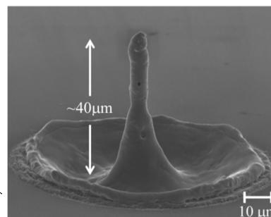
図 4-2 ピコ秒パルス・トポロジカル光波を 10 パルス重ねた打ちした時にできる単結晶シリコンニードル。高さは~40μm、先端曲率半径は~280nm。
