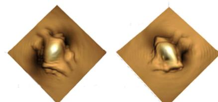
図 3-6 直線偏光のラゲール・ガウスビーム(トポロジカルチャージの符号は(左)プラス(時計周り)、(右)マイナス(反時計周り)である)をアゾポリマーに照射した場合にできる表面レリーフ。レリーフはわずかに回転しているように見えるが質量移動は主として偏光方向(左右)に沿って起こっている。
