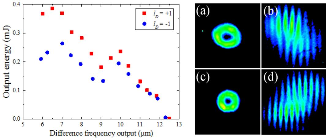
図 2-4 中赤外トポロジカル光波の同調曲線。トポロジカルチャージの符号制御も可能。
