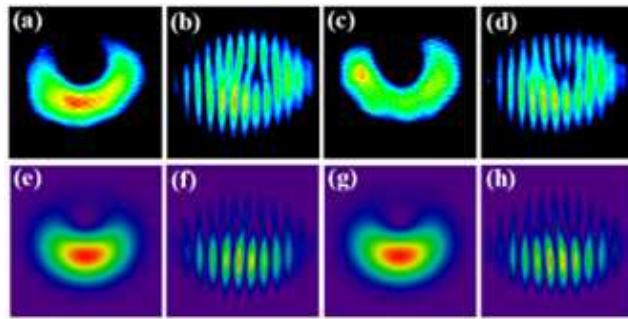
図 2-6 非整数トポロジカル光波(シグナル光)。(上)実験結果と(下)計算結果。開環状強度分布を持つ。また、励起光のトポロジカルチャージの符号を反転させても空間強度分布は変わらない((a)、(b))が、トロジカルチャージの符号は反転することが干渉縞画像からわかる((b)と(d)では符号が反転している)。計算された干渉縞との比較からトポロジカルチャージは~0.5 であると判断できる。
