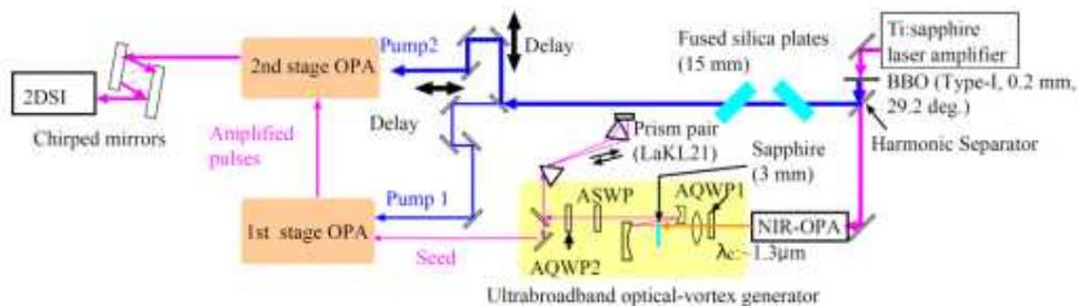
図 6-1 高出力な超短パルス・トポロジカル光波を発生させる実験系。発生したパルスのスペクトル位相は自作の 2 次元スペクトル干渉計(2DSI)により測定する。
