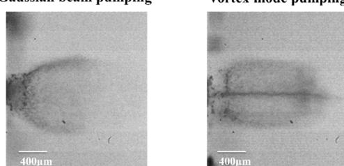
図 4-4 顔料系インクの飛翔運動。トポロジカル光波を照射するとフィラメンテーションが起こる。フィラメンテーションが起こるまでの時間はトポロジカル光波照射から約 1μs。
