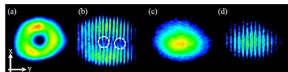
図 2-2 (a), (b) シグナル光の強度分布と波面。(c), (d) アイドラー光の強度分布と波面。
