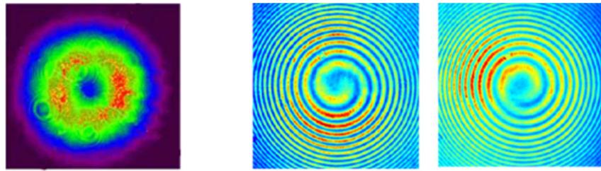
図 1-4 (a) 出力光の空間強度分布。 (b) 出力光波面(時計周り) (c) 出力光波面(反時計周り)
