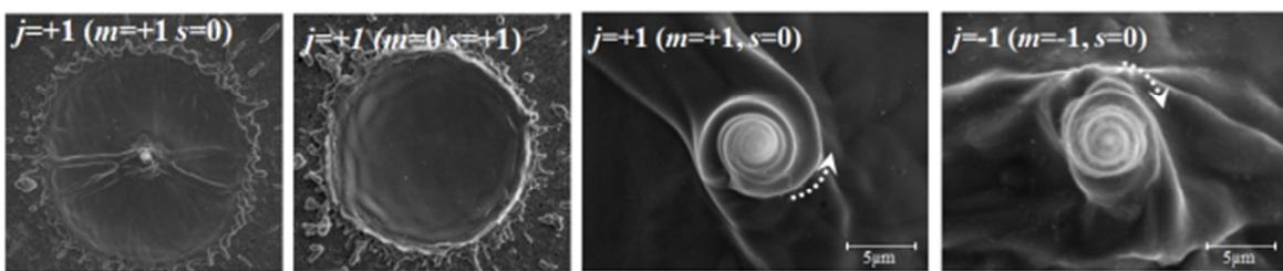
図 3-1 トポロジカル光波による金属ターゲット加工痕の SEM 画像。
