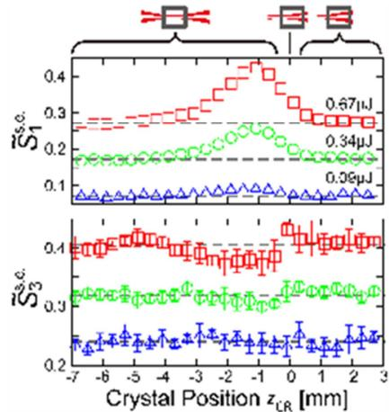
図 8-3  $s=+1, m=-1$  のトポロジカル光波が一軸性結晶中を伝播した際の  $S^{e_1}, S^{e_3}$  値の変化。
