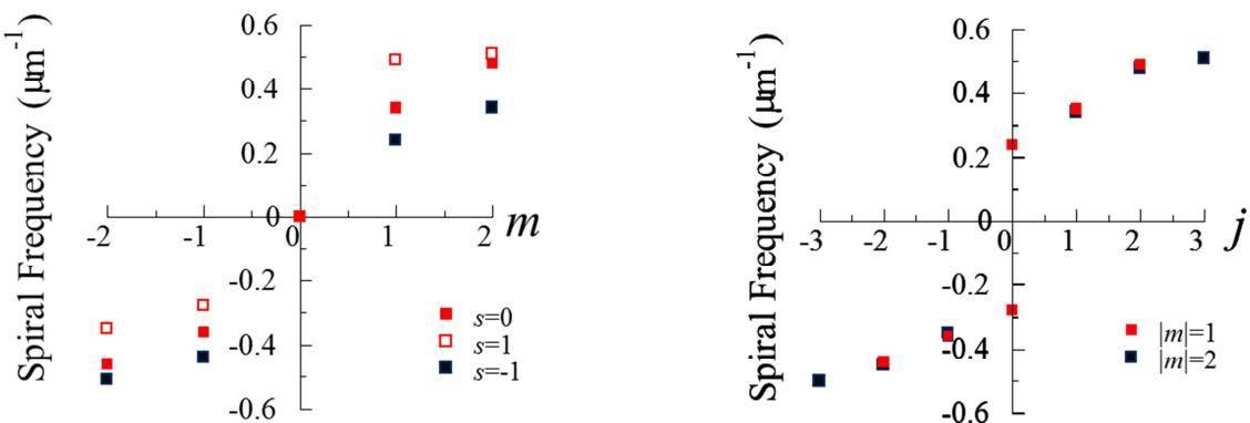
図 3-3 キラル金属ナノニードルの螺旋周波数と軌道角運動量  $m$ 、全角運動量  $j$  との関係。
