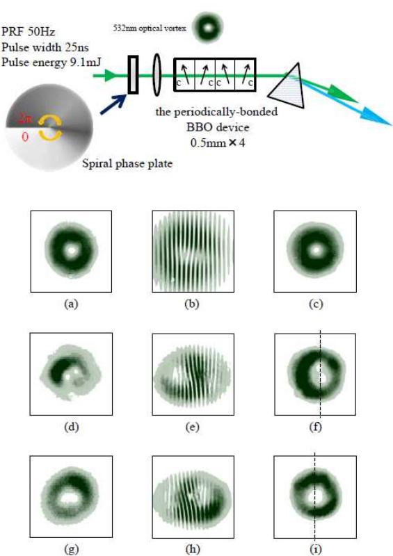
図 1-8 実験配置図と紫外トポロ。 (g)-(i)主軸反転 BBO デバイスを用いた場合の紫外光。
