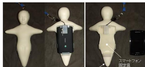
スマートフォンを取り付けた状態 エルフォイドモックアップ(発泡ウレタン)
