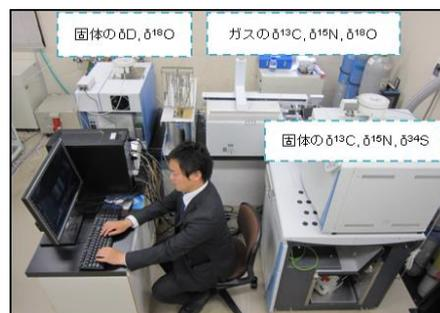
図 3-1-9 熊本大学水文学研究室設置のマルチ同位体分析システム
