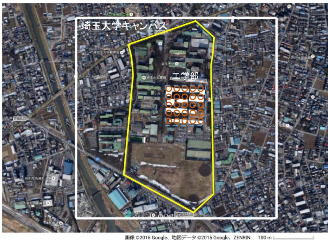
図 3-13-1 黄色線枠が埼玉大キャンパス、青点線枠が工学部、オレンジ丸が仮想的な熱交換井の位置を示す。白線枠は、地下環境リスク予測のために用いた 500 m 四方の計算領域
