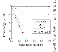
図8. 第一原理計算によって評価した 討 Fe-Al2元系合金の自由エネルギー。
