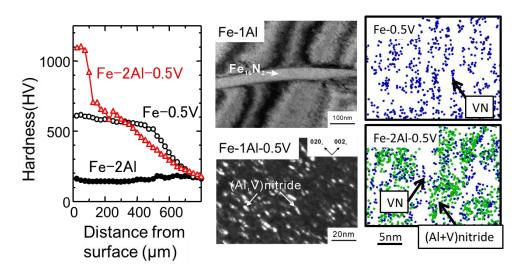
図17. Fe-2at%Al合金に強クラスター生成元素(V)を添加した場合の硬化挙動および窒化層の析出組織の変化(550℃16h 窒化材,単独添加と複合添加の比較).
