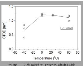
図 30. 大型鋼材の CTOD 破壊靭性 試験
