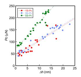
図 20. 種々の固溶ケイ素を含む Fe-Si 二元系合金における *Pc* と*Ah* の関係。
