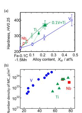
図 13. (a) 923K 変態処理材におけるフェライトの強度と元素添加量の関係, (b) 炭化物の数密度と析出駆動力の関係
