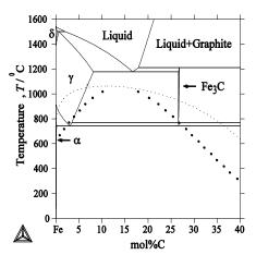
図 2. セメンタイトの非化学量論性を考慮した 図 3 Fe-C 2 元系計算状態図
