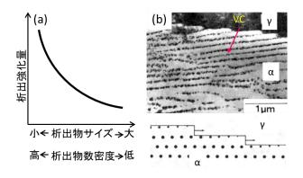
図 12. (a)硬質粒子による析出強化量と析出物分布との相関関係、(b) α/γ 界面での V 炭化物(VC)の相界面析出の透過電顕写真。
