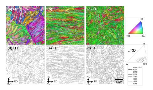
図 22. 通常の焼入焼戻処理した材料 (QT) とテンプフォーミング処理 した材料 (TF) の金属ミクロ組織。0.093%P 材。
