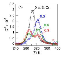
図 11. Fe-Cr-C (a) と Fe-Cr-N (b) 希薄固溶体におけるスヌーク緩和プロファイル。CとNの濃度はそれぞれ約 110 at. ppm、200 at. ppm。
