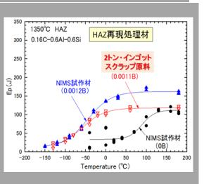
図 29. 大型鋼材での B 添加の効果
