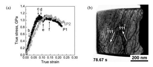
図 21 IF 鋼における TEM その場変形で得られた(a)応力-ひずみ曲線と(b)転位組織を示す TEM 像。大多数の転位線が<111>に平行であり、らせん転位支配型を示している。
