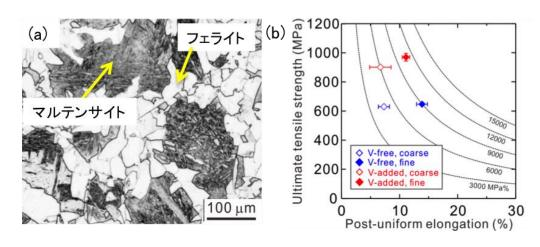
図 15. (a) VC 相界面析出フェライト+マルテンサイト複合組織鋼の光学顕微鏡組織, (b)強度—局部延性バランスに及ぼす複合組織化とフェライト粒径微細化の影響。
