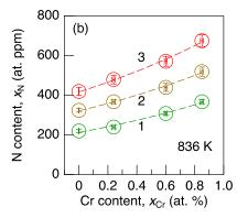
図 9. 一定の C/N 活量の下で浸炭/窒化した Fe-Cr 希薄合金中の C と N の濃度。
