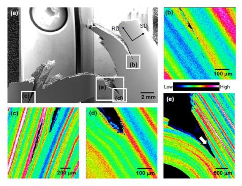
図 24. 0.093%P-TF 開発材のシャルピー試験後のPの EPMA 分析結果。
