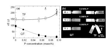
図 23. (a) 室温でのシャルピー衝撃値と P 量の関係および(b)試験後の試料の写真。
