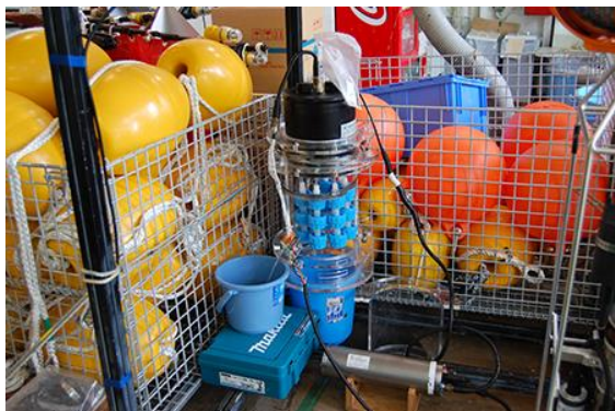
ニホンウナギ産卵行動観察用のカメラシステムに取り付けられた6連型海洋遺伝子アーカイバ
