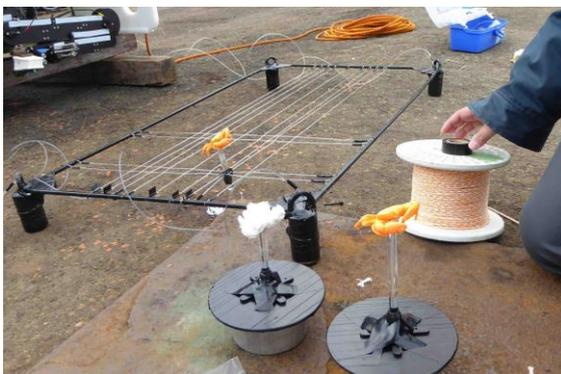
図 3.3.9 実海域試験では、熱水/生物グループらとの連携においてサンプリング対象生物として選定したゴエモンコシオリエビなどの実物大3Dモデルを海底に設置して、ロボット試験を行った。写真の手前右にある白いモデルが、ゴエモンコシオリエビである。
