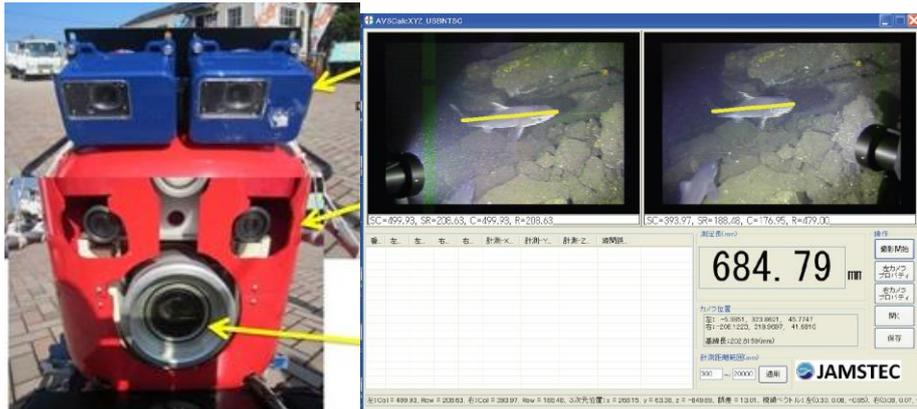
図 3.4.2 左図は PICASSO に取り付けられた2セットの立体カメラと単独カメラ(黄色矢印: 上部の青カメラはワイド視野立体カメラセット、中部の立体カメラは小型生物用で下部の単独カメラは、生物の詳細画像記録のための高精細カメラ)。右図は、立体カメラで計測したサメの体長。サメは斜めになっているが、このシステムを用いることで体長は 68.5cm であることが分かる。
