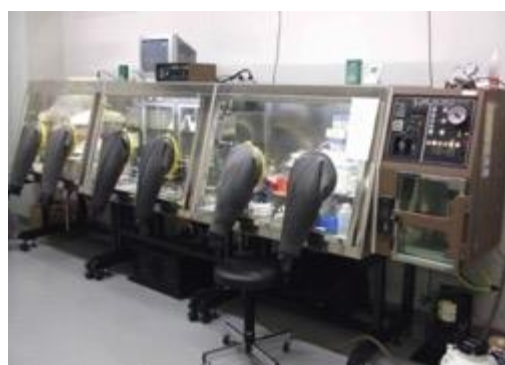
図 3-1 タンパク質結晶化用の嫌気チャンバー
