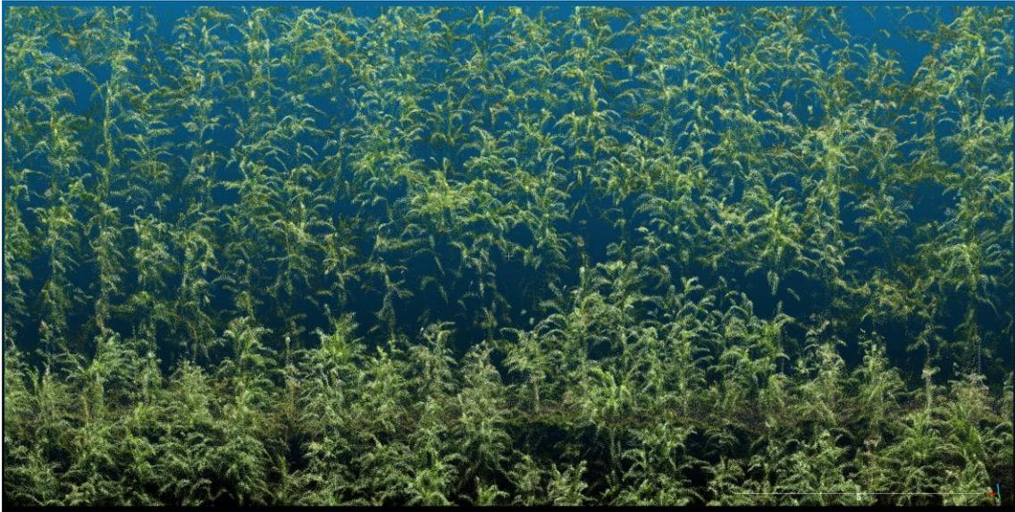
図 2. DJI Phantom4 Advanced で 20m 上空から撮影された画像から再構成された 3 次元点群データ。2017 年の福島圃場の全体（上）と一部クローズアップ（下）。
