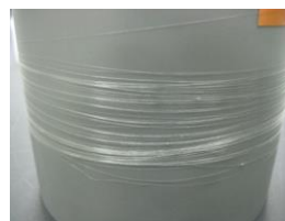
図 14. P (45%LA-co-3HB) (左) および PLA(右)の熔融紡糸繊維
