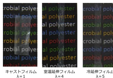
図6 C10 ホモ PHA の延伸フィルム
