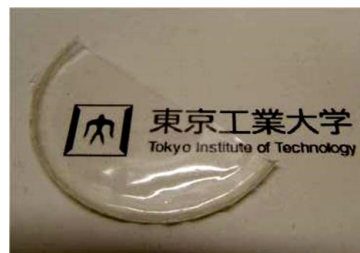
図1 C10 ホモ PHA のキャストフィルム
