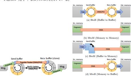
図 1-5 GASNet/TCA における GPU・CPU 間通信のためのパケット通信機構
