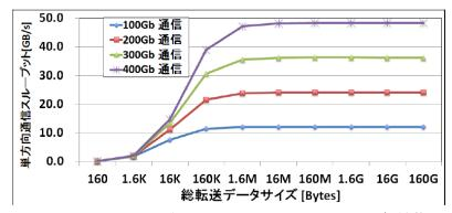
図 1-8 Xlinx FPGA 上の 100Gbps x 4channel での通信性能
