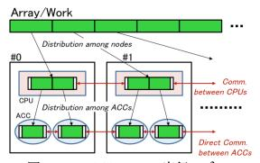
図 3-1. XcalableACC の実行モデル
