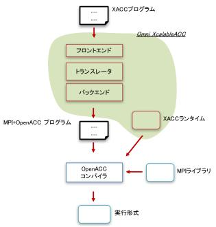
図 3-3. Omni XcalableACC の構成
