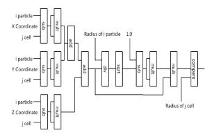
図 2-8 距離判定回路のパイプライン
