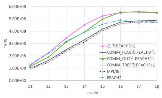
図 2-4 グラフの並列幅優先探索におけるスケールと性能 (TEPS: Traversed Edge Per Second)
