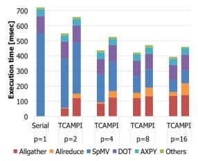
図 1-4 CG 法における 1 反復の処理時間, TCA(左側)と MPI(右側)の比較(p=ノード数, 1 ノード当たり 1GPU, フロリダ大学 Matrix Market の nd6k 行列, 行列サイズは 18,000 行で非零要素数は約 700 万,スパース率は 2.13%)
