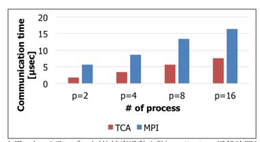
図 1-2 PEACH2 を用いたスカラーデータ(倍精度浮動小数)の allreduce 通信時間と InfiniBand による 通信の比較(1ノード当たり1GPU,1プロセス)
