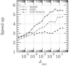
図 4-3: Block time step による速度向上率
