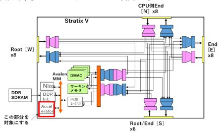
図 2-9 PEACH3 上での AiS 機構の実現
