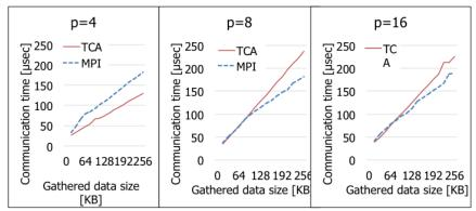
図 1-3 PEACH2 を用いたベクトルデータの allgather 通信時間と InfiniBand による通信の比較 (1 ノード当たり 1GPU, 1 プロセス。p はプロセス数=ノード数)
