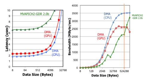
図 1-1 PEACH2 の通信レイテンシとバンド幅:リモートノードの CPU 間及び GPU 間通信と, MVAPICH2-GDR2.0b との比較
