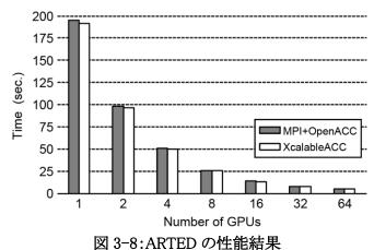
図 3-8 の横軸は GPU 数であり、縦軸は ARTED の時間発展部分の時間を示している。 XcalableACC と比較した MPI+OpenACC の性能は 99~102%であり、XcalableACC とMPI+OpenACC の性能は、ほぼ同等であることがわかる。
