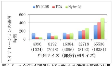
図 3-5. ハイブリッド通信によるステンシル通信の評価の結果
