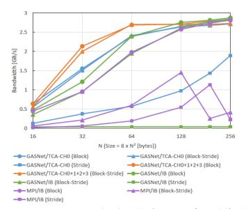
図 1-7 GASNet/GPU における 3 次元矩形領域の halo データ交換性能の比較
