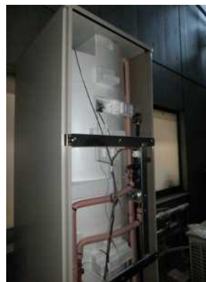
図 A-1. 実験利用した HPWH と計測系 (左: 電源部と各データ収集用のログー 右: 温度計測用のセンサーをとりつけた貯湯タンク)
