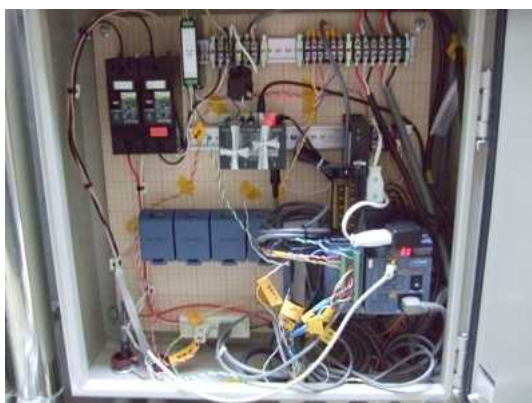
図 A-1. 実験利用した HPWH と計測系 (左: 電源部と各データ収集用のログー 右: 温度計測用のセンサーをとりつけた貯湯タンク)
