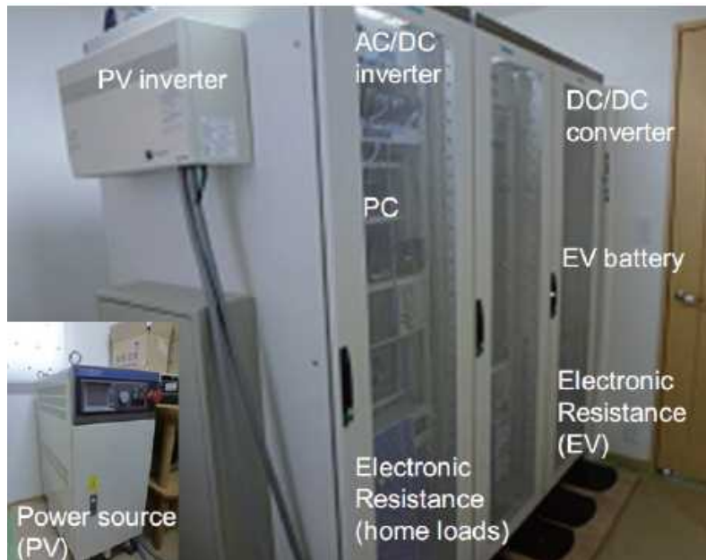
図 3.5-1 HEMS 検証実験用プロトタイプ試験機
