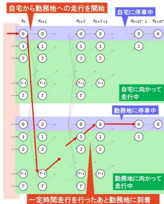
図 3. 4-5 自宅と勤務地間の走行を考慮した車使用モデルの概要
