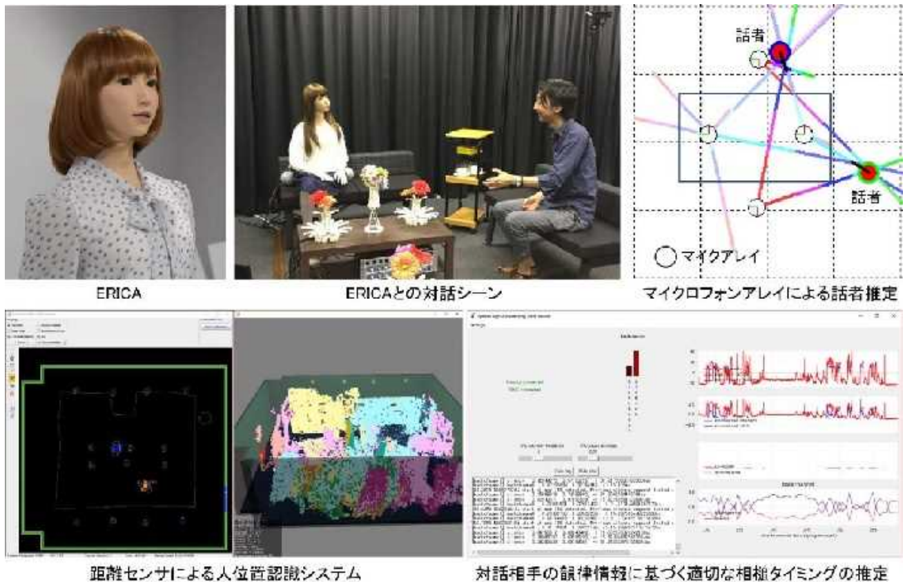
図 3: アンドロイド ERICA のマルチモーダル対話制御システム
