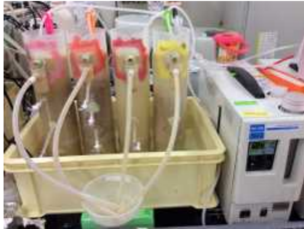
図 4.1 効率的な水素供給と高い窒素除去性能を達成した水素酸化脱窒リアクター
