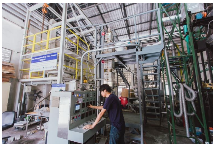
図 4-27 循環流動層 (CFB) の操作状況
