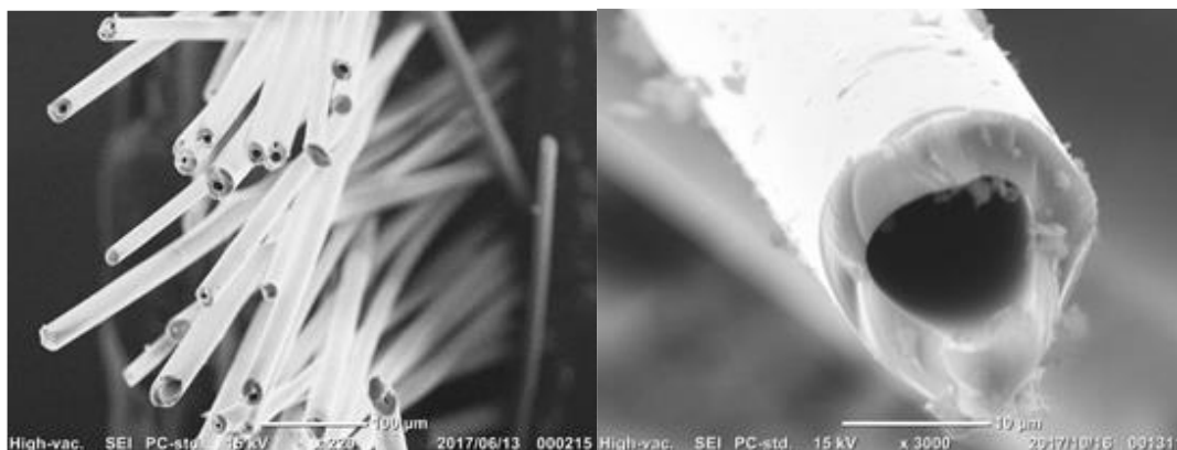
図 3-5 処理した RS Soluble (300°C- 80 min) から調製した炭素繊維 (CF300°C- 80 min) の SEM 写真
