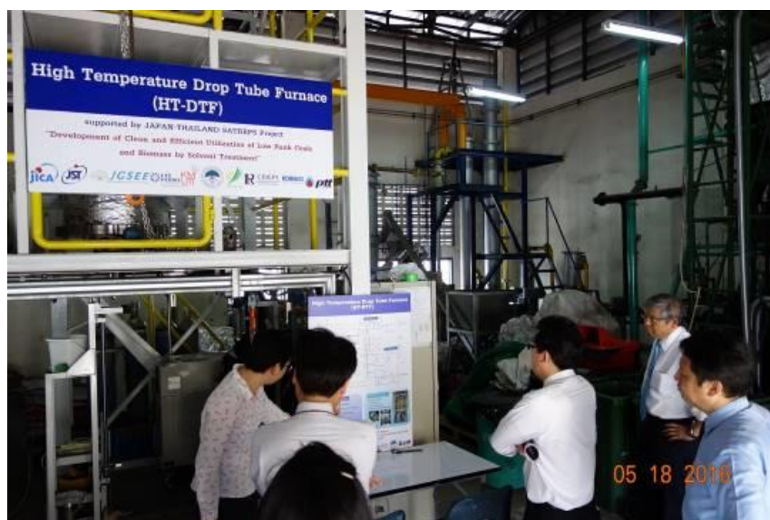
図 0-3 平成 28 年 1 月に JGSEE/KMUTT に導入したドロップチューブ炉 (0.1 kg/h)
