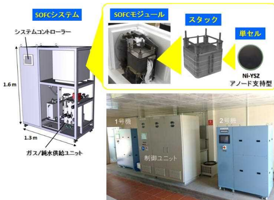
図 27 : 2017 年 12 月に実証サイト（ベトナム・ベンチェ省 Hoang Vu エビ養殖場）に設置した東南アジア初の 1 kW 級バイオガス SOFC システム
