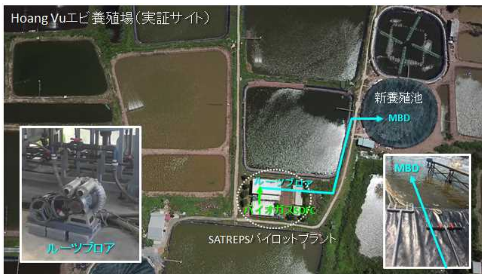
図 69 : ベンチェ実証サイトにおけるバイオガス SOFC 発電電力の供給
