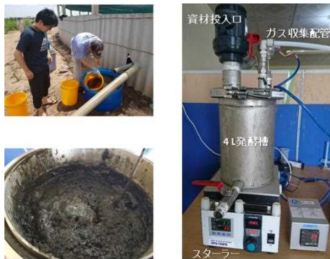
図 39 : エビ養殖池ヘドロを用いたメタン発酵ラボ試験 ; (左上) 実証サイト養殖池からのヘドロ回収の様子、(右) 4 L メタン発酵ラボ試験装置 (@ベンチェ実証サイト)、(左下) 発酵試験中の発酵槽内の様子
