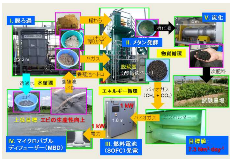
図 3：ベトナム・ベンチエ省ビンダイ地区の Hoang Vu エビ養殖場（実証サイト）内に構築したバイオマス廃棄物利用エネルギー循環システムのパイロットプラント：（上）実証サイトの位置（Google マップ）、（下）プラントの全体像
