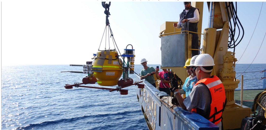
写真 A-1-2: 海底地震計・圧力計の設置風景
