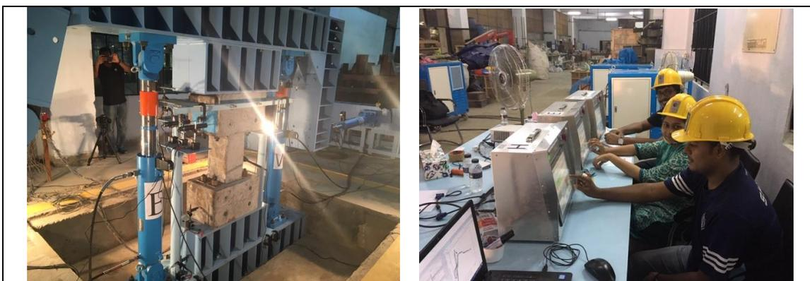
写真3 BUETでの本実験（供与機材であるフレームとジャッキ・計測機器を使用）（2018年7-12月）
