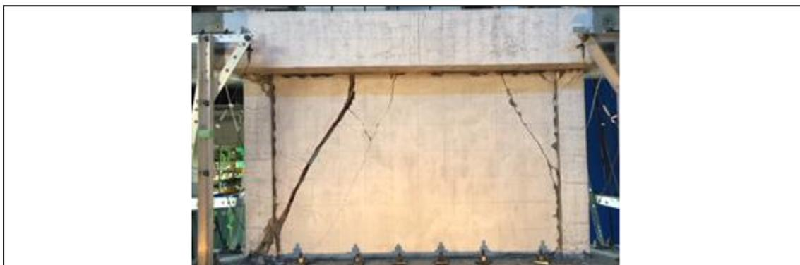
写真 22 フェロセメント試験体の最終破壊状況（2018 年 12 月，東北大学）
