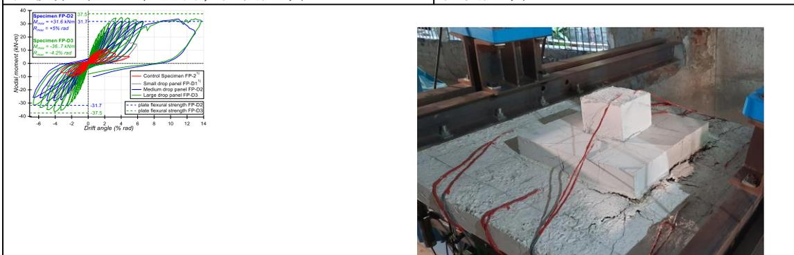
図 25 サイズの小さいドロップパネル補強試験体 (右) と荷重—変形関係 (左, 無補強が赤線で、大きな耐力と変形能力の向上がみられる)
