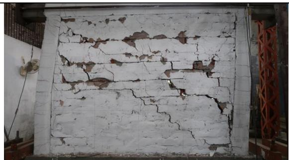
写真10 RC+MIWの破壊状況@HBRI (2019年2月)
