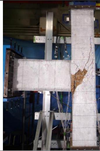
写真 14 梁主筋の抜け出し破壊
