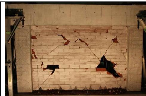
写真9 RC+MIWの破壊状況@東北大学 (2016年)
