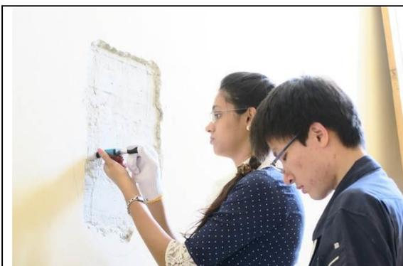
写真 17 非破壊検査法の実建物への適用
