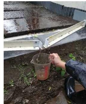
図 3.3.5 流出物回収の様子
