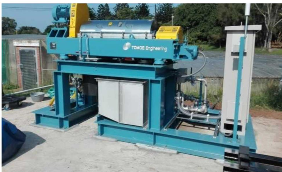
図 4-2 微細藻類回収装置の外観
