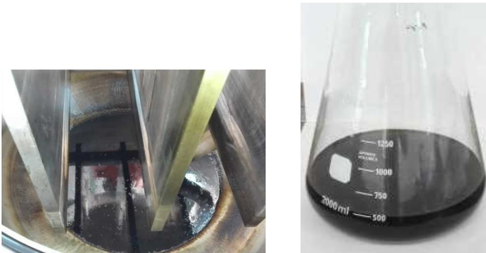
図 4-6 (左) 蒸発器の底部に溜まった油脂、(右) 取り出された油脂 (エタノール希釈)
