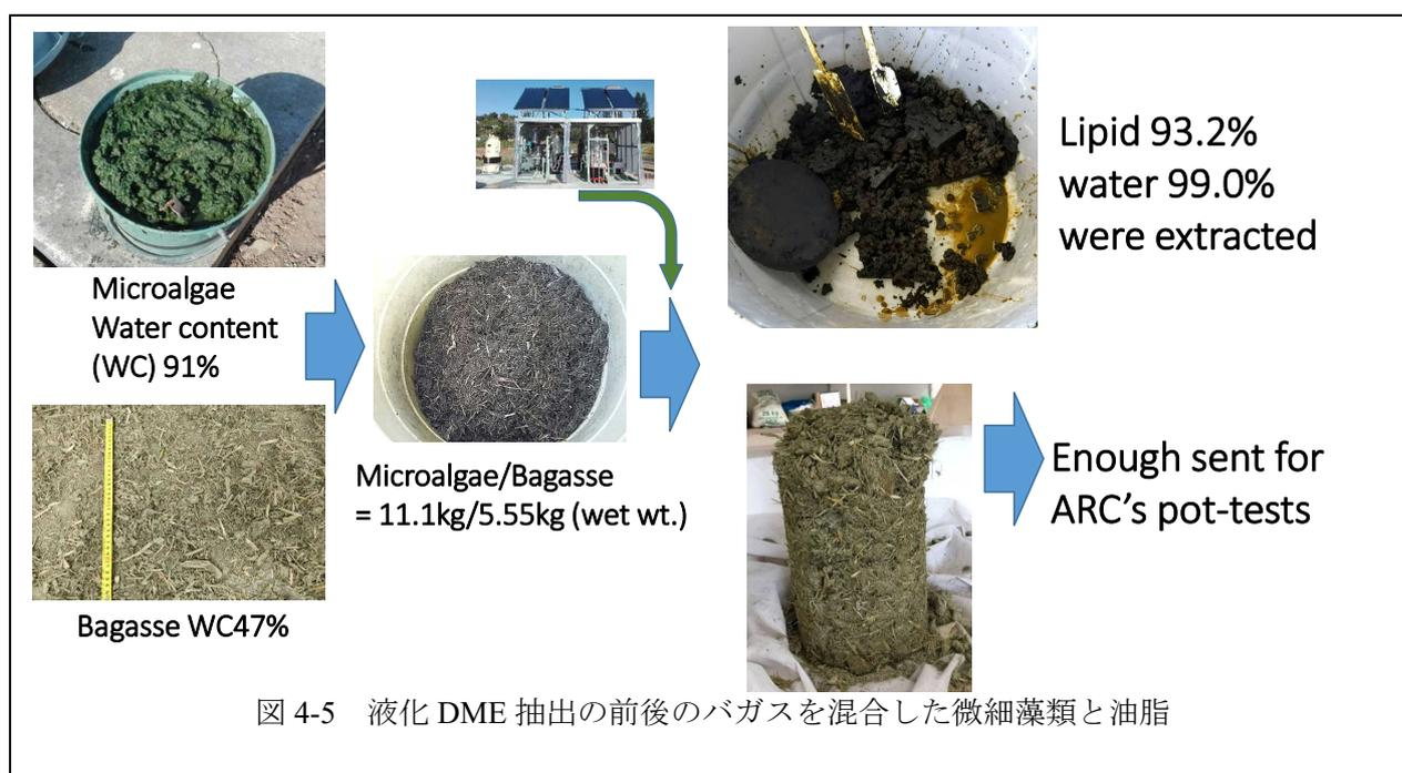
図 4-5 液化 DME 抽出の前後のバガスを混合した微細藻類と油脂
