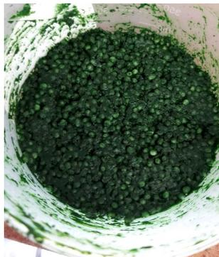
図 4-9 液化 DME 抽出前の微細藻類とセルロース球の混合物
