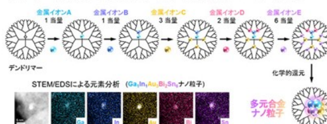
dendリマーを鋳型とした多元素合金ナノ粒子の合成法(アトムハイブリッド法)
