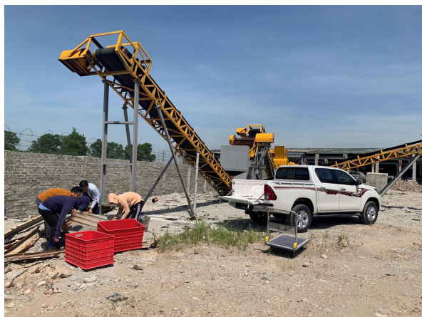
ハノイ市内に設置した破砕機（現在は同敷地内の屋根の下へ移設）。左：全景及び供与車両、右：試験的による製造したコンクリート碎石
