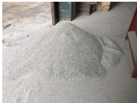
ハノイ市内に設置した破砕機（現在は同敷地内の屋根の下へ移設）。左：全景及び供与車両、右：試験的による製造したコンクリート碎石
