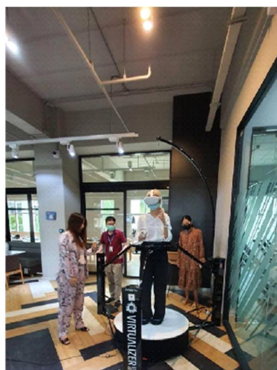
図 39 トレッドミルを用いた Walkability 評価の実験の様子
