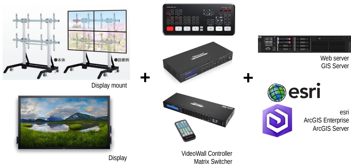
図 98 デジタルアースシステム（ハードウェア）の構成検討図
