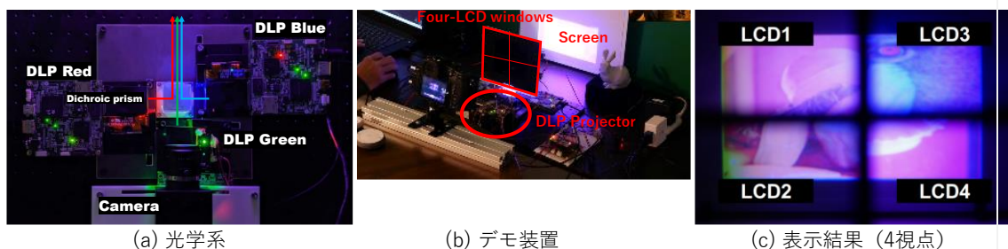
図2. 開発した多視点ディスプレイ。4 つの液晶シャッターの窓を覗くと、4 つの異なる映像が見える。
