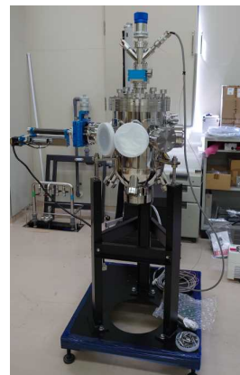
図 5 試料作製用超高真空蒸着チャンバー
