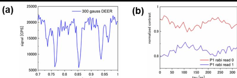
図5: (a) DEER計測によるデルタドープ薄膜中のP1センタ検出
