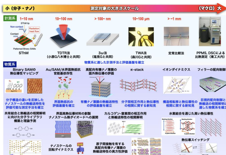
図1. 本研究内容の概要。(上段)熱物性計測技術基盤、(下段)これまでに実施した様々な形態、スケールを有する有機物質の熱輸送特性の計測。
