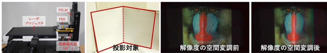
図 5: PSLM を用いた空間解像度変調(くの字面右側の画像の伸びが改善)
