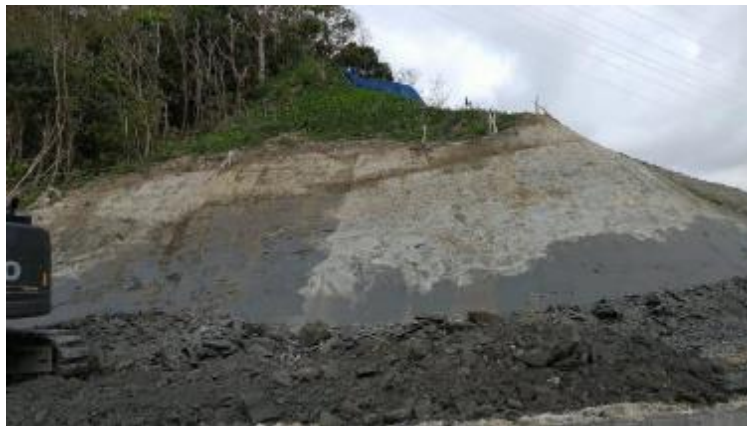
図4 八重瀬町役場裏の崖にみられる島尻層群（泥岩）。客土に使われているもの。挟まれている茶色い層が凝灰岩層。泥岩と凝灰岩の両方を分析した。
