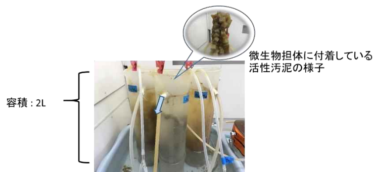
図-1 空気と窒素ガスを交互供給する下水処理リアクターのラボスケール試作機
