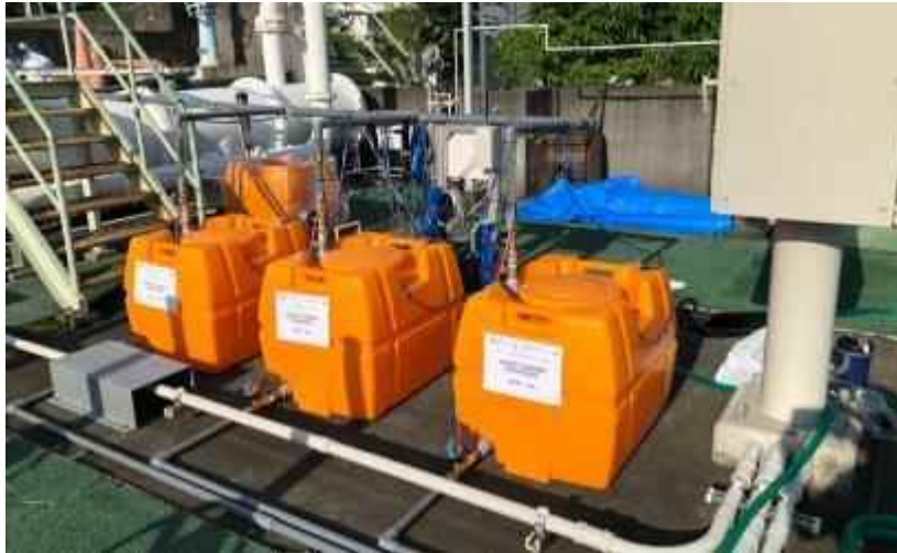
図A-1 峡東浄化センターに設置したベンチスケール空気・水素ガス交互供給式浄化槽
