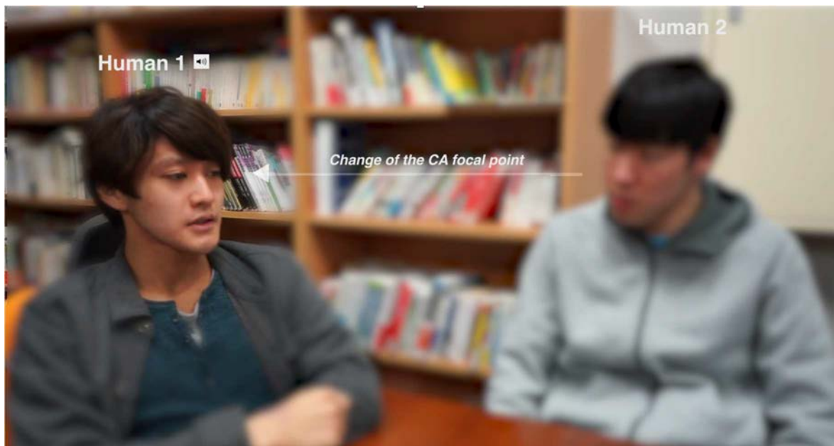
図1. 作成したプロトタイプシステムのスクリーンショット。対話者のラベルと、発話中である表示 (Human 1)、CA の視線の移動を軌跡として表示している。また、操作者の操作の負担を軽減させるため、操作者が注目すべき点以外ぼかす効果を追加した。
