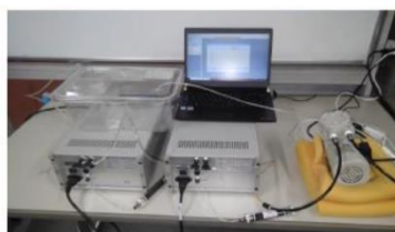
図5 マウスの呼気ガスモニタリングシステムの写真(左図)と対応する模式図(右図)
