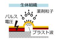
図 2 粒子射出の動作原理
