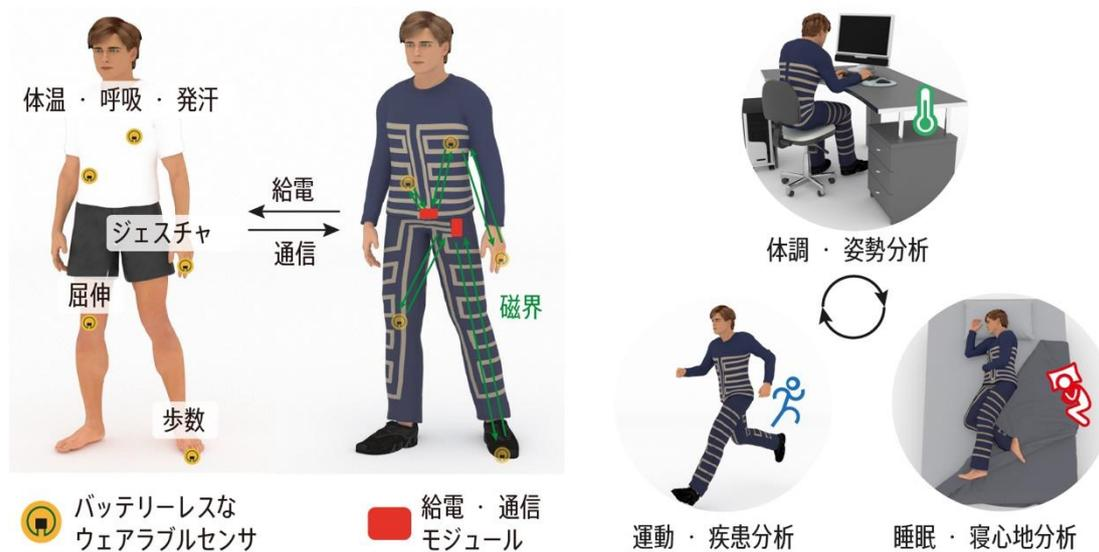
図1:本研究の狙い。人体スケールのテキスタイル型コイルを用いて、全身の色々な所にあるバッテリーレスな無線センサコイルを長時間駆動する。
