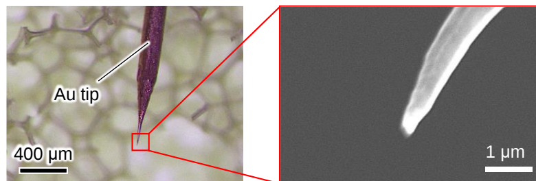
図 1 上部電極として用いられた Au 探針の光学顕微鏡像及び、先端付近の SEM 像。小さな先端曲率半径を有する探針が電解研磨法により作製された。
