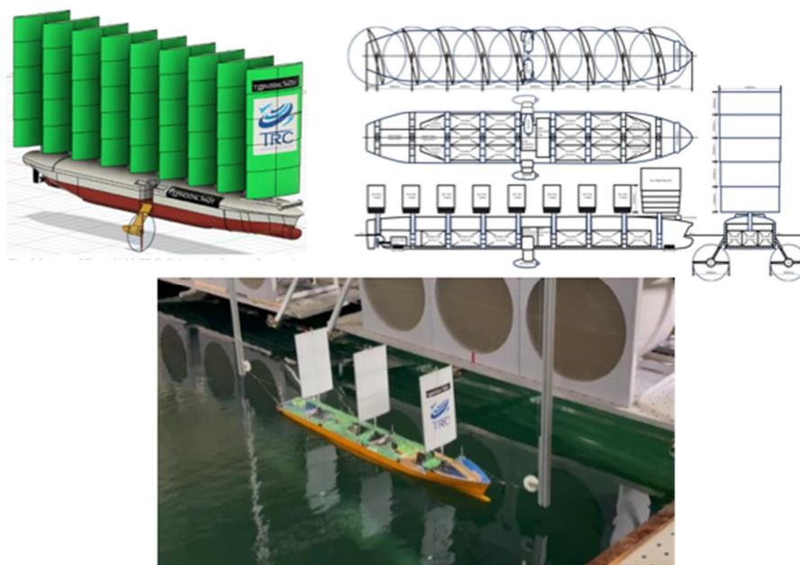
図1. 台風発電船の模型作成と台風环境下の風・波を想定した水槽実験
