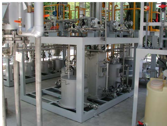
図 3.1.14 相分離系変換システムプラント (リグノフェノール精製工程)
