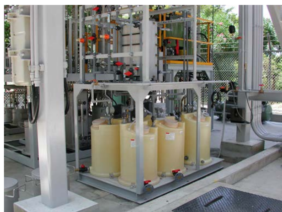
図 3.1.15 相分離系変換システムプラント (糖質分離・酸回収工程)
