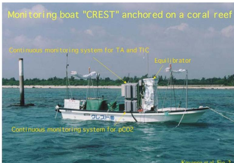
写真1 統合型CO<sub>2</sub>計測システム「クレスト号」。石垣島白保サンゴ礁において、1998年9月から1999年9月まで1年間の通年観測を行なった。電源は発電機で、日常のメンテナンスは地元の漁民に依頼した。
