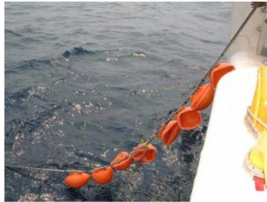
海底立ち上げ表層係留ブイが急潮のため海面下に引き込まれ、破壊された。もう1つの表層ブイにより辛うじて回収。
