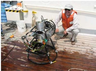
浮上したブイに船舶が接触して大破、破壊されたのは運良くダミーセンサーだけで、データロガー・バッテリーは無事。
