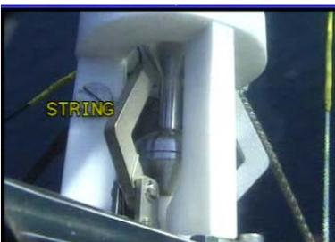
3: 水中降下時の計測パイの錐もみ状態の把握（画面右の緊張ロープの挙動から）
