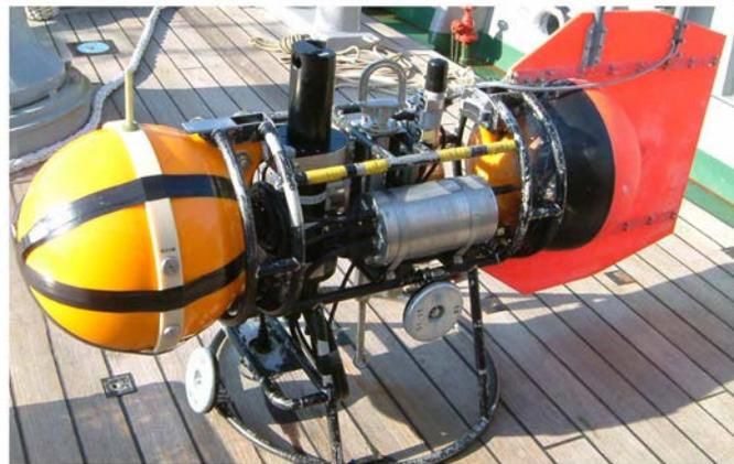
図 4.2.22 自動昇降ブイにセットした現場型 FRRF
