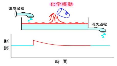
図 4.3.1 化学摂動法による消失過程測定の概念図
