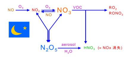
図 4.2.10 NO<sub>3</sub>/N<sub>2</sub>O<sub>5</sub> を中心とした夜間大気中 NOx 反応系
