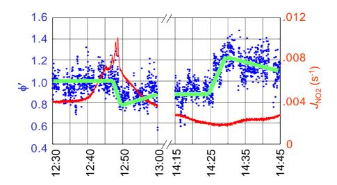
図 4.2.8 都市大気における  $J_{NO2}$  (細実線) およびラジカル濃度の短時間変動に対する、NOx 光化学定常状態係数  $\phi$  (黒丸) の応答 (大阪府立大学、2002年8月).太線は、 $\phi$  の定性的な変化を表したもの.左は  $J_{NO2}$ 、右はラジカル濃度急変時.
