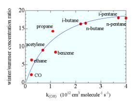
図 4.1.10 炭化水素の冬と夏の比と OH ラジカルとの反応速度定数の関係
