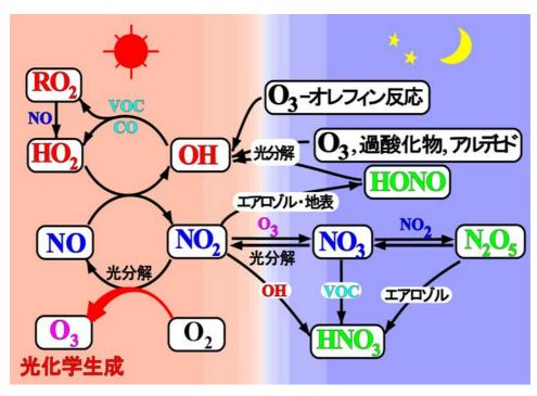
図1 大気反応機構概略図
