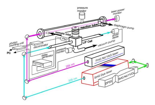
図 4.3.2 OH ラジカル大気寿命測定装置概略図
