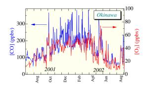
**図 4.1.12** 沖縄での CO、O<sub>3</sub>の季節変化 (青: CO、赤: オゾン)
