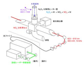
図 4.2.11 LIF 法 NO<sub>3</sub>/N<sub>2</sub>O<sub>5</sub> 測定装置の概略
