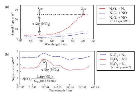
図 4.2.13 校正時の励起スペクトル
