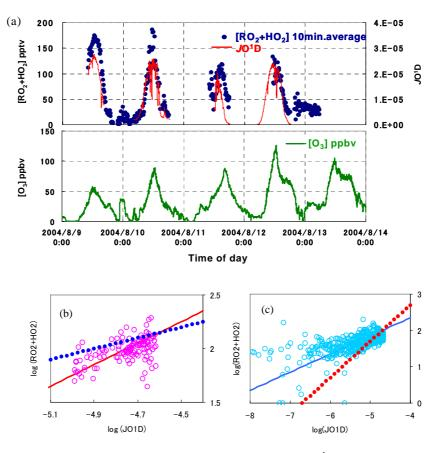
図 4.2.6 過酸化ラジカル濃度実測値と  $O_3$  光解離係数  $J(O^1D)$  の関係
