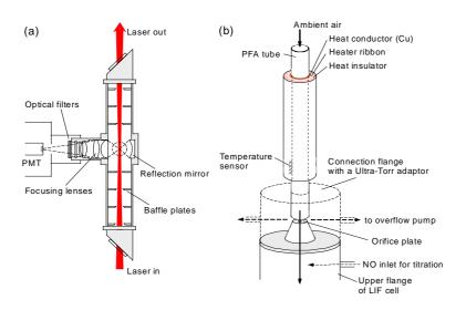
図 4.2.12 (a)  $NO_3$  検出セルと励起レーザーの光路 (b)  $N_2O_5$  熱分解用ヒーター管、および インレット
