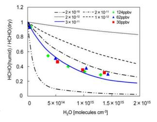
図 4.1.3 陽子移動反応質量分析計における HCHO 信号の水蒸気依存性
