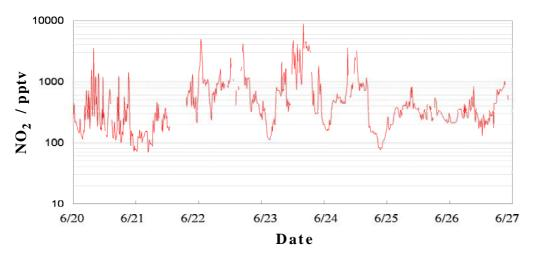
図 4.2.3 LIF 法による清浄海洋大気中 NO2 濃度測定結果(利尻島 2000 年)
