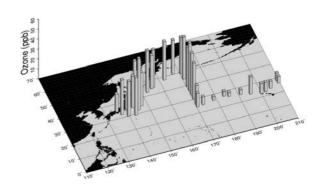
図 4.1.22 IOC2002 航海での O<sub>3</sub> 濃度分布
