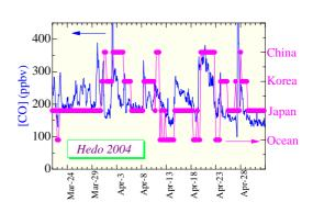
図 **4.1.13** 春季沖縄の CO 濃度と空 気塊起源の関係
