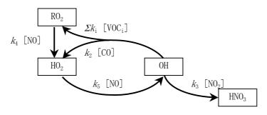
図 4.3.10 オキシダントポテンシャル計算で考慮する反応スキーム
