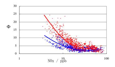
**図 4.3.11** オキシダントポテンシャルの NOx 依存性 (青:61種類の化学分析結果、赤:OH寿命測 定結果)
