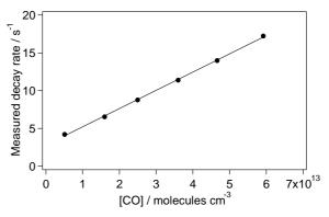
図 4.3.4 OH 反応速度の CO 濃度依存性
