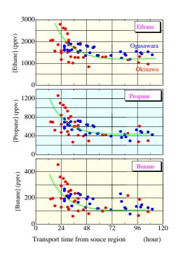
**図 4.1.15** 炭化水素濃度と輸送時間の関係(青:小笠原、<mark>赤</mark>:沖縄)
