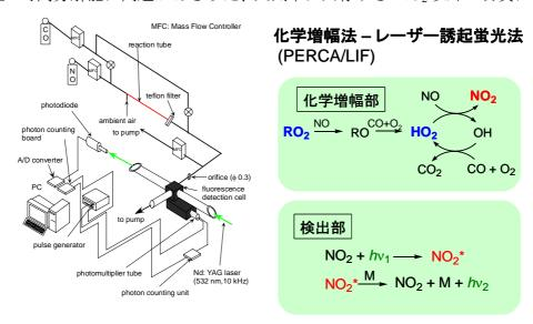
図 4.2.4 PERCA-LIF 法による過酸化ラジカル測定の原理と装置
