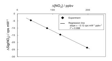
図 4.2.14 校正における NO 添加時の  $NO_2$  濃度変化および  $NO_3$  信号変化の関係。相関直線の傾きが、 $NO_3$  検出感度を表す
