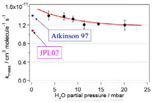
図 4.3.6 OH+NO2 反応速度定数の水依存性
