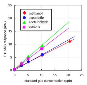
図 4.1.2 陽子移動反応質量分析計の検量線
