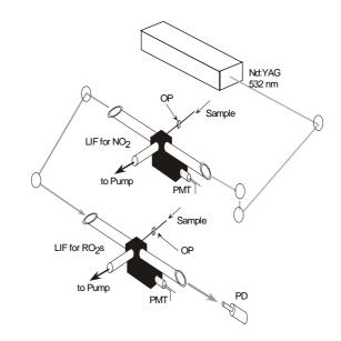
図 4.2.5 過酸化ラジカル・NO<sub>2</sub> 同時測定装置 の概略. OP: 流量・圧力調整用オリフィス板、PD: レーザー強度変動モニタ 用フォトダイオード.
