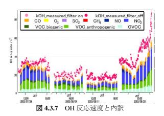
ターを装着しエアロゾルを除去したが結果は変化しなかった(図 4.3.7 の薄いピンクがフィルター装着時で濃いピンクが脱着時)。また同時に観測したエアロゾル表面密度に対して取込み係数を 1 と仮定してエアロゾル寄与を見積もったが 3 割の不一致を説明するには全く不十分であった。現在は 3)の可能性である未知なる OH ラジカルとの反応相手が最も有力であると考えられる。図 4.3.7 に夏季に得られた計算による反応速度とその内訳を色分けして示した。OH 反応で最も重要なものは VOCs との反応であり全体の 40% を占める。次に重要な反応相手は  $NO_2$  である。その次に重要なのは未知なる反応相手であり、やはり 20% 以上の寄与があった。不一致の起こる状況は大気が清浄な場合でも汚染がひどい場合でも起こることがわかる。
