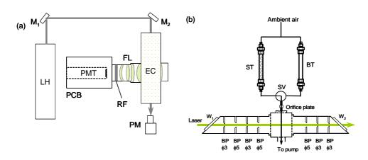
図 4.2.2 LIF 法 NO<sub>2</sub> 測定装置の概略
