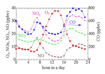
図 4.1.5 東京都立大学で観測された 11 月の 各汚染物質の平均濃度の日変化
