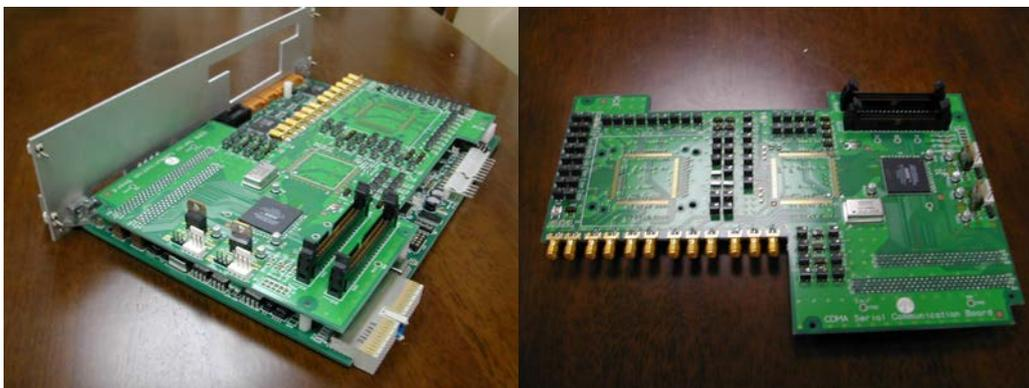
図 12 CDMA通信ボードの写真 left: DSPボードと接続, right: ボード単体
