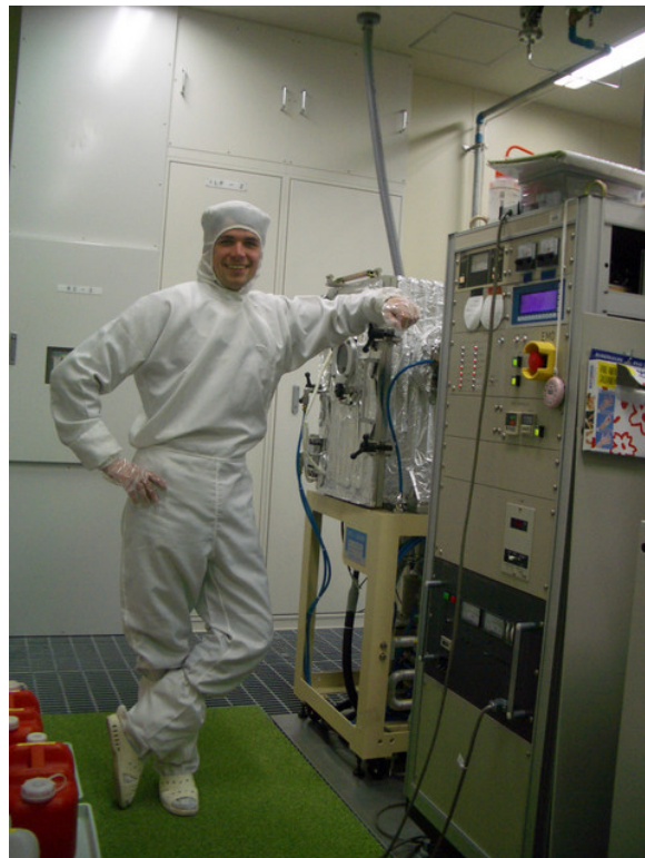
電極形成用電子ビーム蒸着装置と研究員
