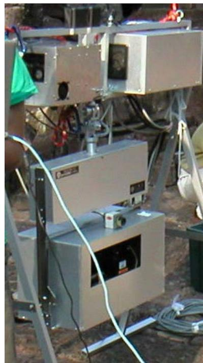
図3.1.2 FLRS (Flying Laser Range Sensor) 試作機
