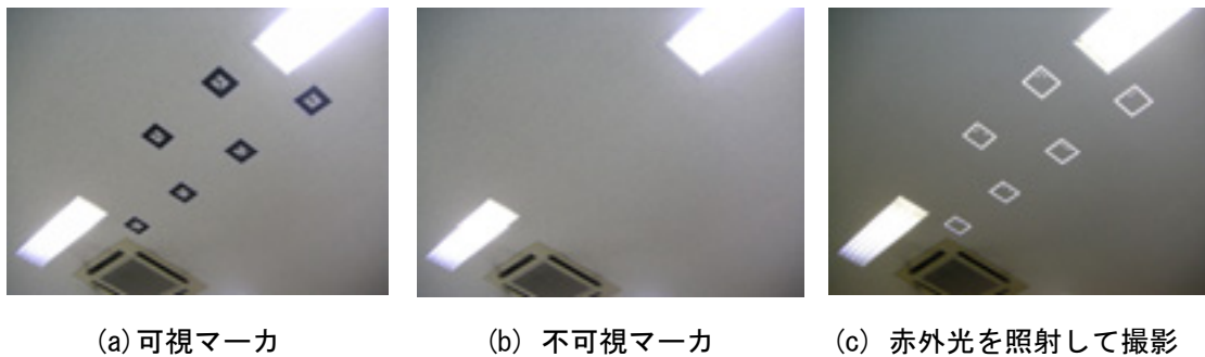
図 3. 1. 10 不可視マーカ（半透明再帰性反射材）
